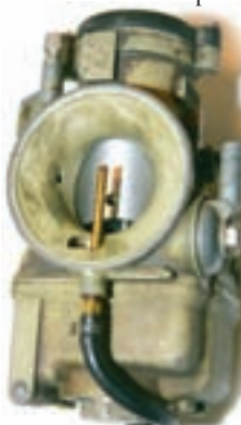
Karburator dell'orto PHB-e promjer 32 s "Power jet" mlaznicom izrađen u magnezijevoj leguri. Plovcu su neovisni, a fiksiran je preko elastične gumene antivibracijske prirubnice
