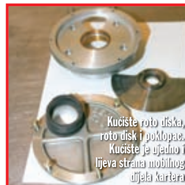
Poklopac mjenjača i primarnog prijenosa s davačem impulsa elektronskog sustava paljenja tipa "Krober"
