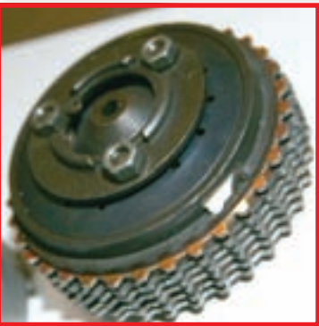
▲ Suha spojka sa nazubljenim lamelama. Potisna ploča je dijafragma (lisnata radijalna opruga), komanda je mehanička preko ručke, sajle i osovinice koja oslobađa pritisak opruge i odvaja motor od mjenjača
